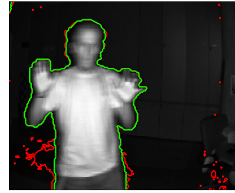
Figura 4. Resultado de la segmentación de fondo en una imagen de ejemplo perteneciente a una de las secuencias de test. En rojo se representa el resultado obtenido al utilizar únicamente la imagen de intensidad y en verde el resultado tras incorporar la información de profundidad
