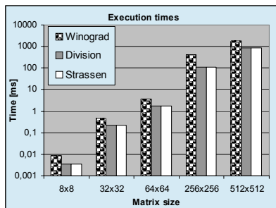
Figura 6. Tiempo de ejecución de la FPGA para los algoritmos evaluados, con diferentes tamaños de matrices.
