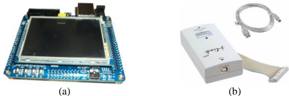
Fig. 3. (a) Tarjeta de desarrollo miniDK2. (b) Adaptador JTAG (Joint Test Action Group) para depuración.
