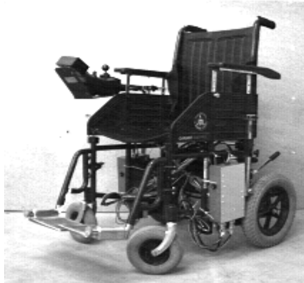
Figura 3.4. La Silla de Ruedas Autónoma empleada en la aplicación
