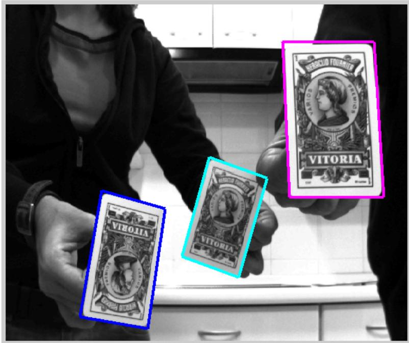
Figura 6.23: **RANSAC utilizando el modelo de cámara proyectiva.** En esta imagen se muestra el perfil de reproyección del objeto detectado tras aplicar RANSAC junto con el modelo de cámara proyectiva.
