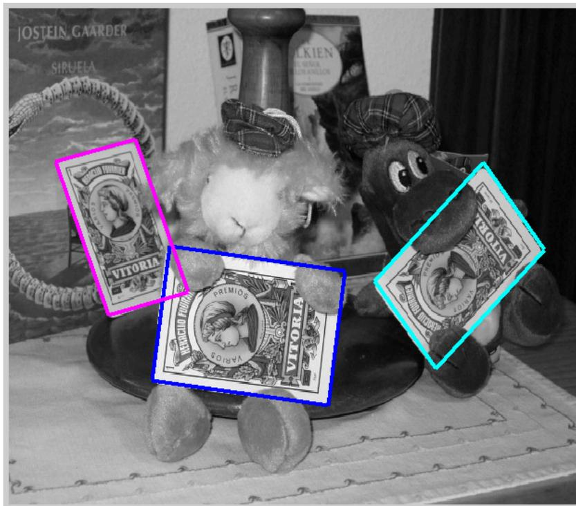
Figura 7.87: **Resultados y simulaciones.** En esta imagen se muestra el perfil de reproyección de cada objeto detectado tras aplicar RANSAC junto con la aproximación afín.
