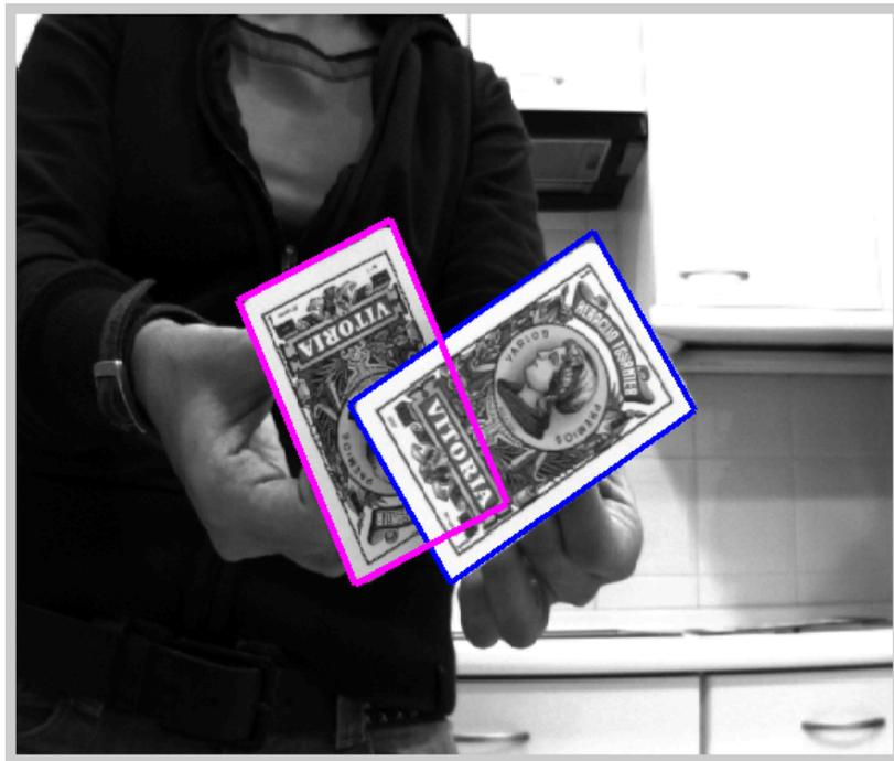
Figura 6.15: **RANSAC utilizando el modelo de cámara afín.** En esta imagen se muestra el perfil de reproyección del objeto detectado tras aplicar RANSAC junto con la aproximación afín.
