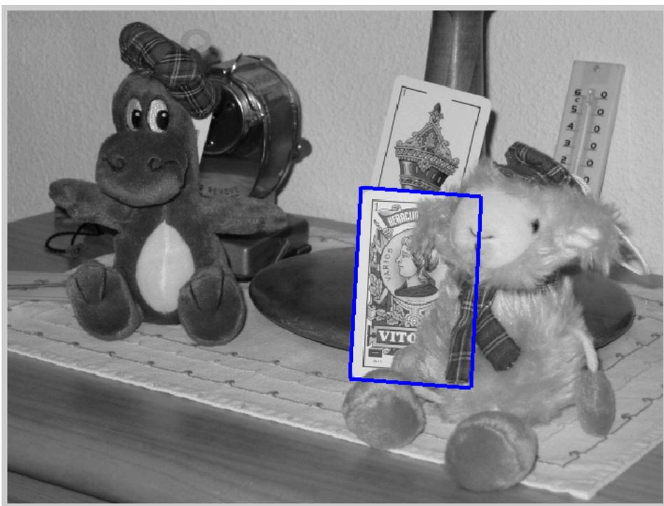
Figura 7.8: **Resultados y simulaciones.** En esta imagen se muestra el perfil de reproyección del objeto detectado tras aplicar RANSAC junto con la aproximación afín.
