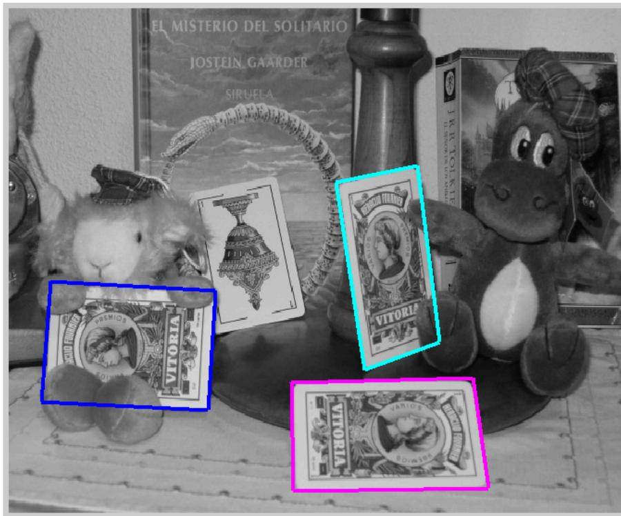
Figura 7.92: **Resultados y simulaciones.** En esta imagen se muestra el perfil de reproyección de cada objeto detectado tras aplicar RANSAC junto con la aproximación afín.
