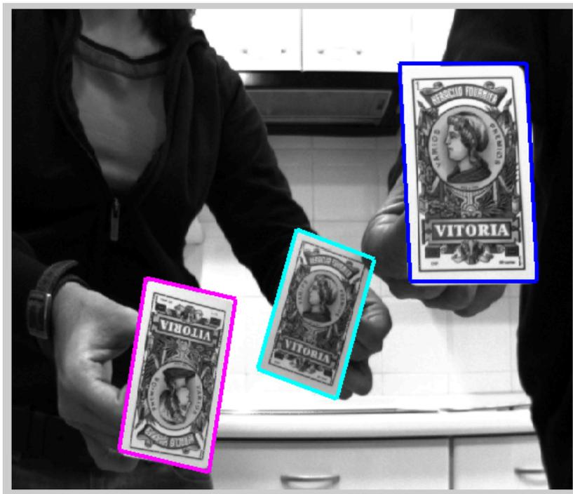
Figura 6.11: **RANSAC utilizando el modelo de cámara afín.** En esta imagen se muestra el perfil de reproyección del objeto detectado tras aplicar RANSAC junto con la aproximación afín.
