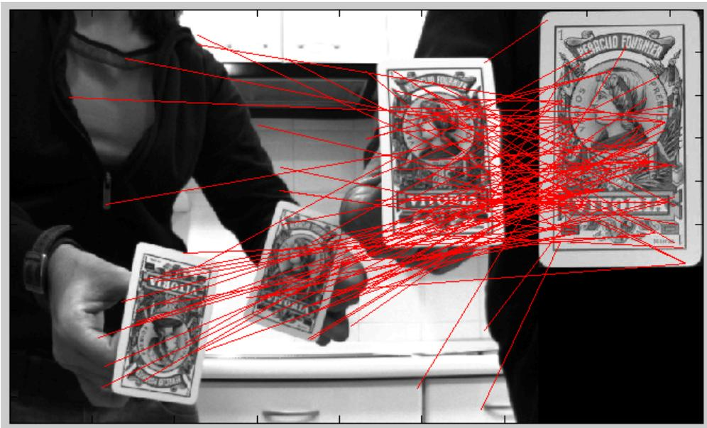
Figura 6.22: **RANSAC** utilizando el modelo de cámara proyectiva. En esta imagen se muestran los “outliers” tras aplicar RANSAC junto con el modelo de cámara proyectiva.
