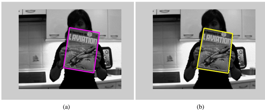
Figura 7.52: **Resultados y simulaciones.** En estas gráficas se muestra un ejemplo de detección utilizando el modelo de cámara proyectiva cuando el objeto se encuentra alejado de la cámara. En la imagen se puede apreciar como el perfil estimado del objeto se adapta perfectamente al objeto. (a) Conjunto de “inliers” detectados por RANSAC. (b) Perfil estimado del objeto detectado.
