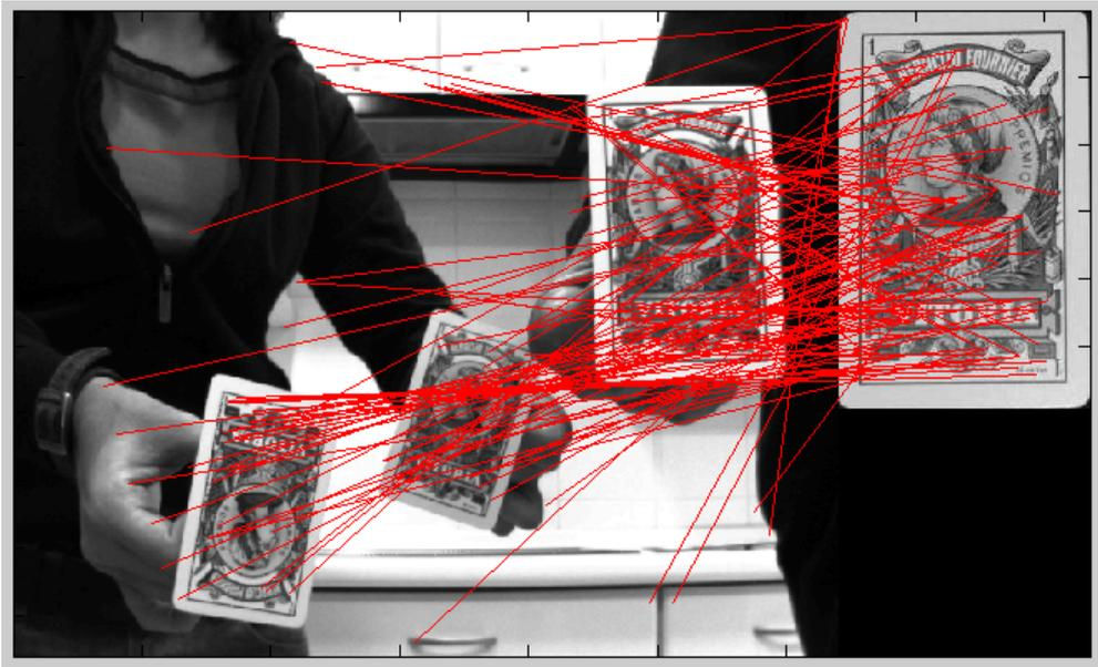
Figura 6.10: **RANSAC utilizando el modelo de cámara afín.** En esta imagen se muestran los “outliers” tras aplicar RANSAC junto con la aproximación afín.
