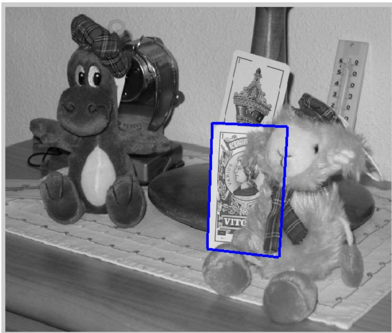
Figura 7.24: **Resultados y simulaciones.** En esta imagen se muestra el perfil de reproyección del objeto detectado tras aplicar RANSAC junto con la aproximación afín.
