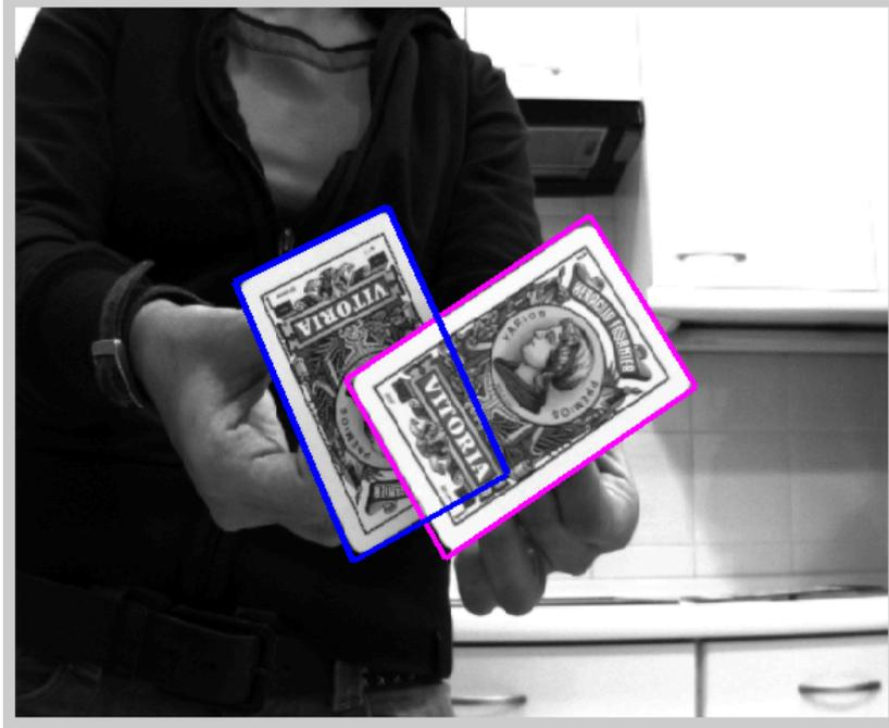
Figura 6.27: **RANSAC utilizando el modelo de cámara proyectiva.** En esta imagen se muestra el perfil de reproyección del objeto detectado tras aplicar RANSAC junto con el modelo de cámara proyectiva.
